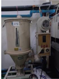
(เตาอบแบบเดิม โหลดเม็ดพลาสติก ให้เครื่องฉีดฯ ได้ 1 เครื่อง)
