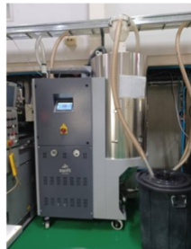
(เครื่องอบเม็ดพลาสติกแบบใหม่ โหลดเม็ดพลาสติกให้เครื่องฉีดฯ ได้ 3-4 เครื่อง)
